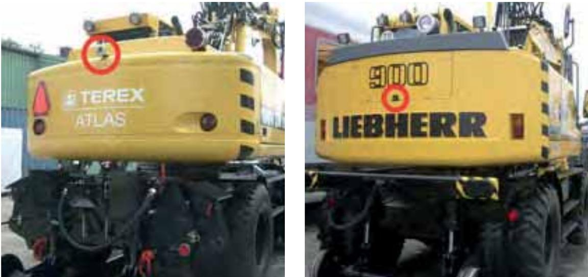
Abb. 7-7: Die Rückraumüberwachung ist für Zweiwegebagger Standard (rechts: Kamera in den Oberwagen integriert).
