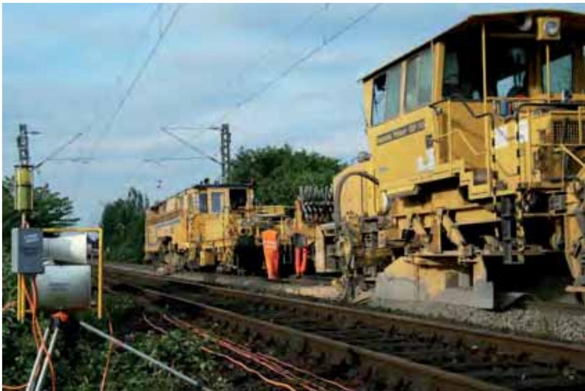
Abb. 9-1: Stopfmaschine (im Hintergrund, mit Messtrupp) und Schotterplaniermaschine.
