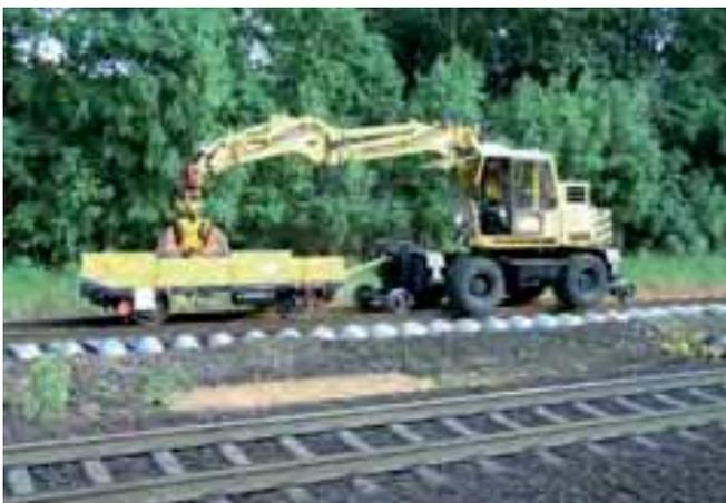
**Abb. 7-3:** Bei Transporten mit dem Zweiwegebagger sollten Bahnwagen eingesetzt werden, um auf Mitgänger zum Führen angeschlagener Lasten verzichten zu können.
