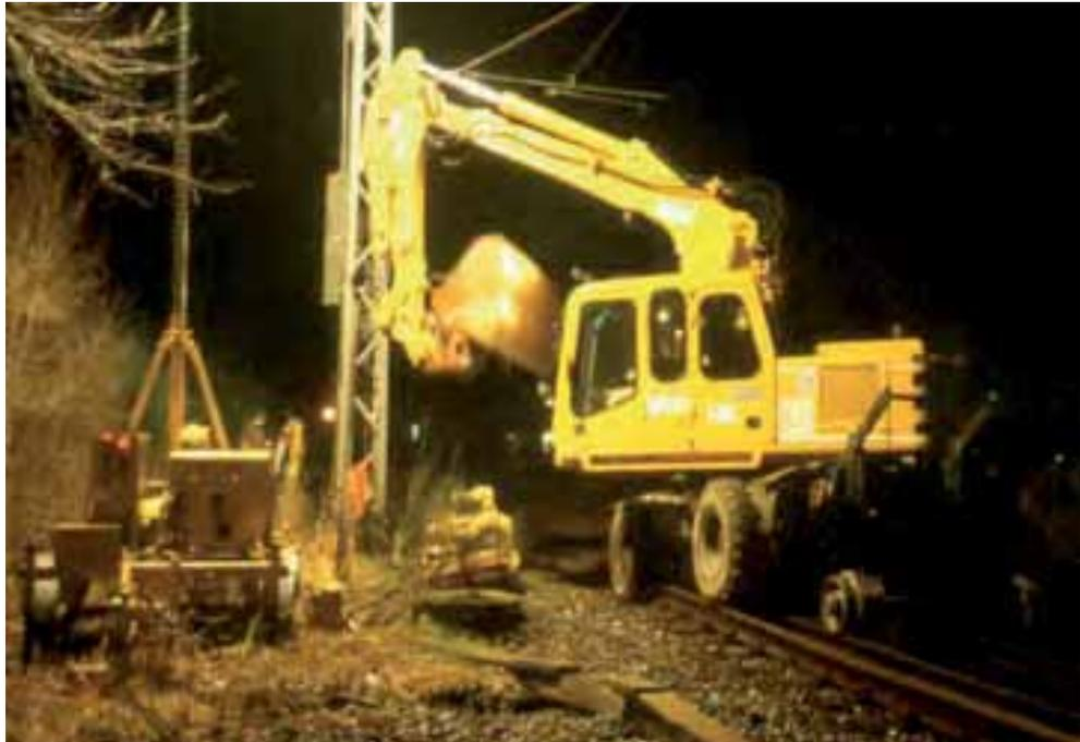
Abb. 7-23: Beim Verlassen der Schienen geht die Bahnerdung verloren.
