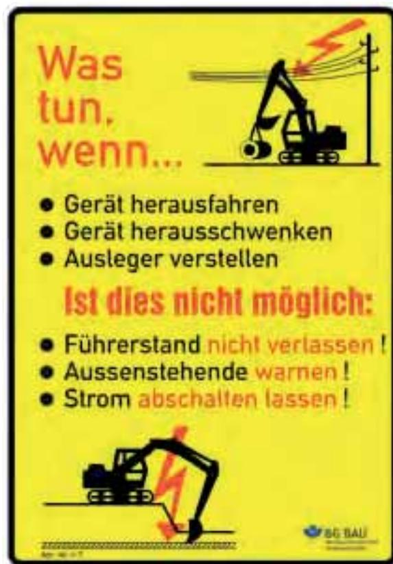
Abb. 4-13: Verhaltensanweisung als Aufkleber für die Kabine der Erdbaumaschine.
