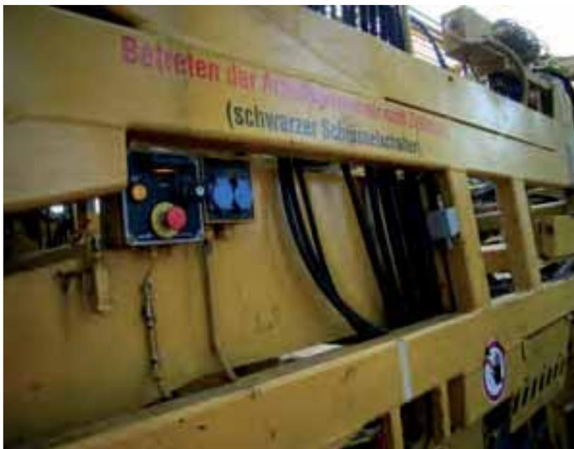
**Abb. 8-12:** Das Betreten der Gefahrenbereiche der Arbeitseinrichtungen ist nur zulässig, wenn diese gegen ungewollten Wiederanlauf gesichert sind (Beispiel: Umbauzug).
