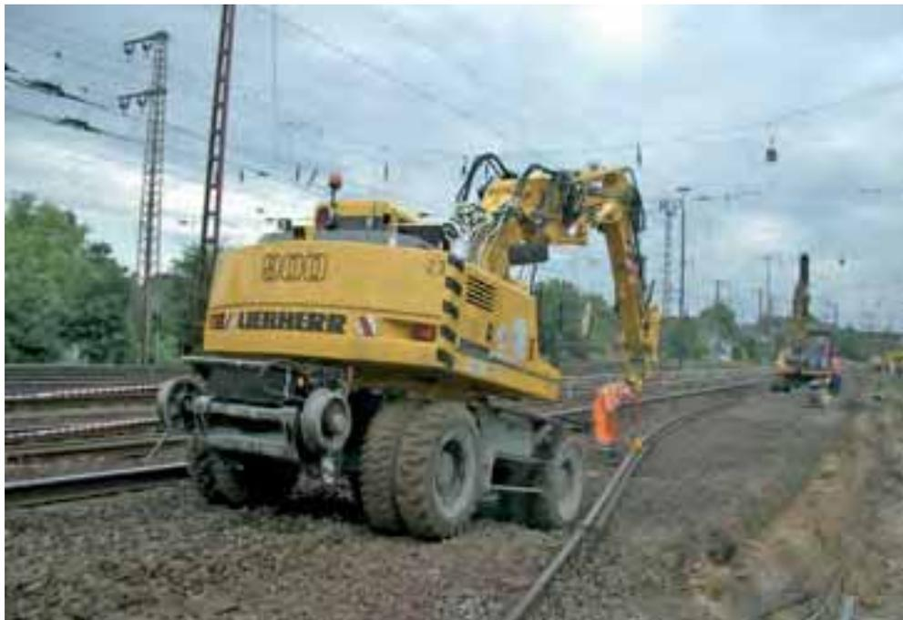
Abb. 7-24: Bei unebenem Gelände kann der Schutzabstand zur Fahrleitung durch die Längsneigung des Unterwagens unterschritten werden. Warnkleidung ist geschlossen zu tragen.
