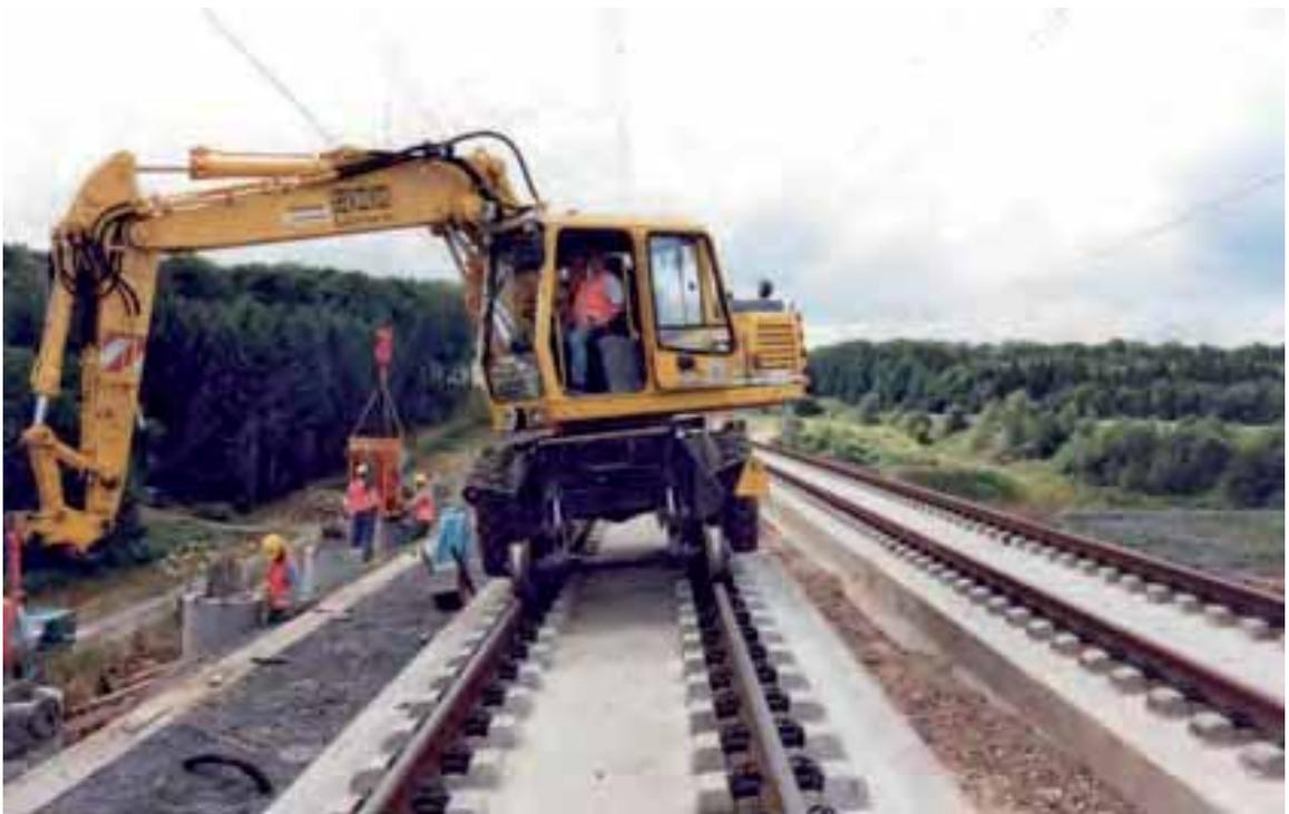
**Abb. 7-10:** Auf dem Gleisfahrwerk liegt die Kippkante des Baggers wesentlich weiter innen als auf dem Straßenfahrwerk. Die Gleisüberhöhung im Bogen verringert die Standsicherheit.
