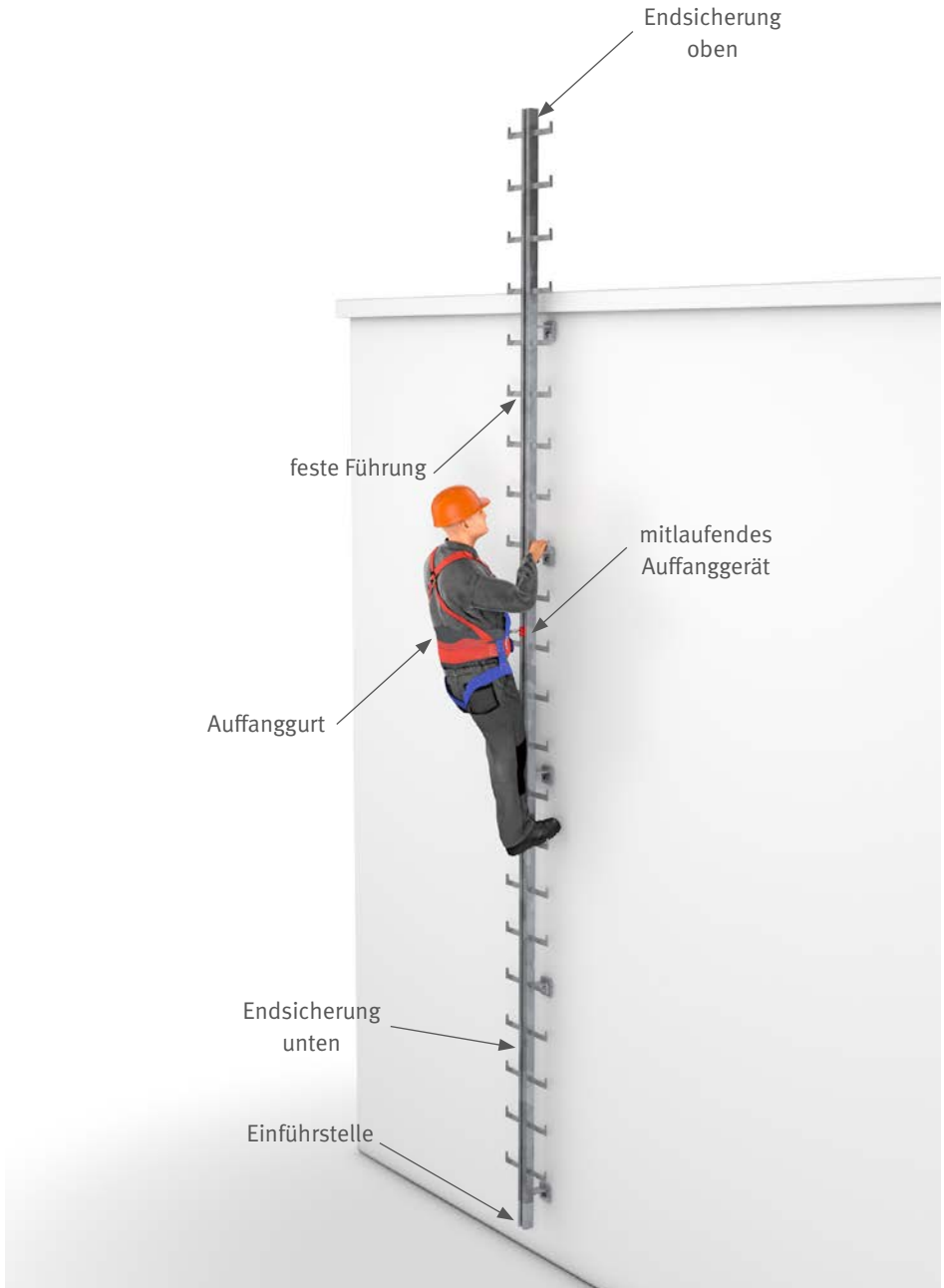
Abb. 1 Beispiel für eine Steigschutzeinrichtung
