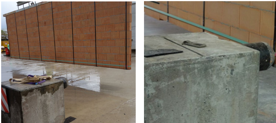
Abb. 25 Prüfung der Stoßbeanspruchung im Großversuch an einer geschosshohen Wand
