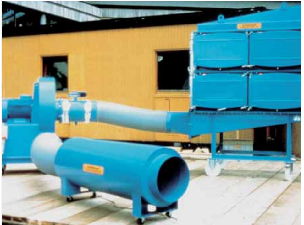
Luftaustauschgerät zur Unterdruckhaltung
