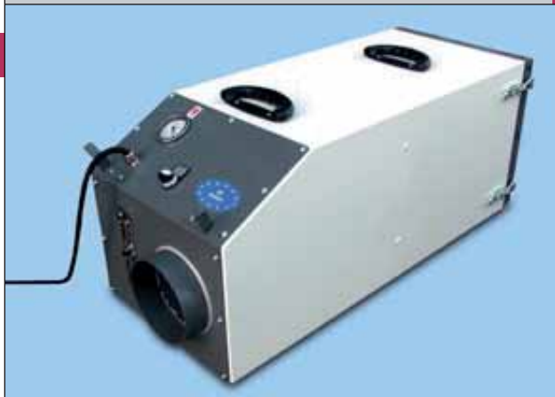
Luftaustausch-/Unterdruckhaltegerät mit 3-stufigem Filtersystem und einer Luftleistung von 900 m 3 /h, Gewicht 24,0 kg, geeignet für kleinere Räume (Quelle Deconta)
