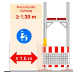
Querabsperzung/Kennzeichnung eines Gerüsts ohne Arbeitsraum neben dem Gerüst
