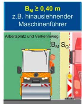
Darstellung der vorgeschriebenen Mindestbreiten ( B_M ) in Abhängigkeit von der Tätigkeit Abbildungen: Langer, BG BAU
