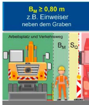
Darstellung der vorgeschriebenen Mindestbreiten ( B_M ) in Abhängigkeit von der Tätigkeit Abbildungen: Langer, BG BAU
