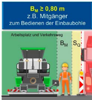
Darstellung der vorgeschriebenen Mindestbreiten ( B_M ) in Abhängigkeit von der Tätigkeit Abbildungen: Langer, BG BAU
