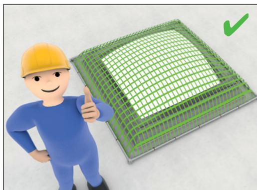
Предохранить световые купола/люки от проваливания
