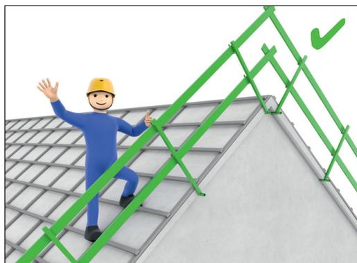
Защитное ограждение на торце крыши
