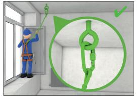
Крепление только при помощи проверенных мест крепления к опоре
