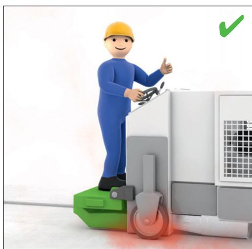
Utilizar máquinas com aspiração
