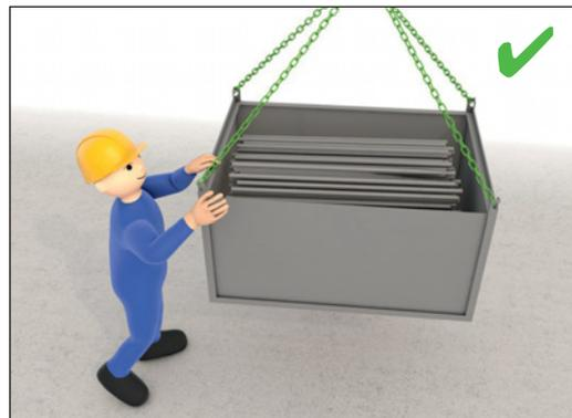
Utilizar dispositivos de suspensão com quatro partes
