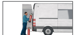
Eingesetzte Feuerlöscher nicht mehr aufhängen und neu füllen lassen
