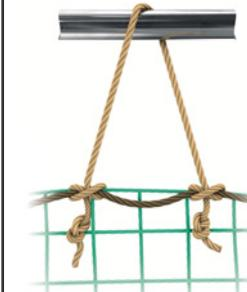
Seile sind gegen Aufdrehen zu sichern und dürfen durch scharfe Kanten nicht beschädigt werden. ③
