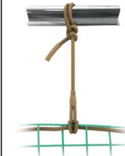
Netzaufhängung durch Umschlingen und Verknoten des Aufhängeseiles am Tragelement.
