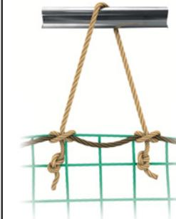
Seile sind gegen Aufdrehen zu sichern und dürfen durch scharfe Kanten nicht beschädigt werden. ③
