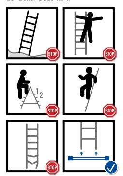
Gezeigt wird ein Auszug von generellen Regeln für die sichere Verwendung von Leitern. Die Gebrauchsanleitung zur Leiter enthält weitere wichtige sicherheitsrelevante Hinweise für die Verwendung der jeweiligen Leiterbauart.
