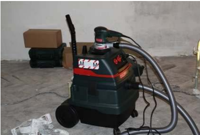
Entstauber der Staubklasse M mit Steckdose zum Anschluss von Maschinen und Kennzeichnung der Staubklasse M nach DIN EN 60335-2-69 (Schriftfeld mit weiß-rot schraffierter Umrandung)
