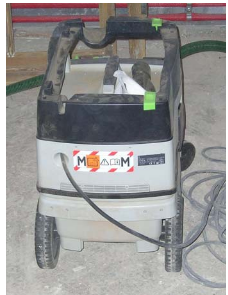
Entstauber der Staubklasse M mit Steckdose zum Anschluss von Maschinen und Kennzeichnung der Staubklasse M nach DIN EN 60335-2-69 (Schriftfeld mit weiß-rot schraffierter Umrandung)
