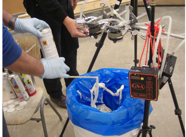
Abbildung 3: MDI-Messungen beim Ausbringen von Montageschaum in eine Tonne
