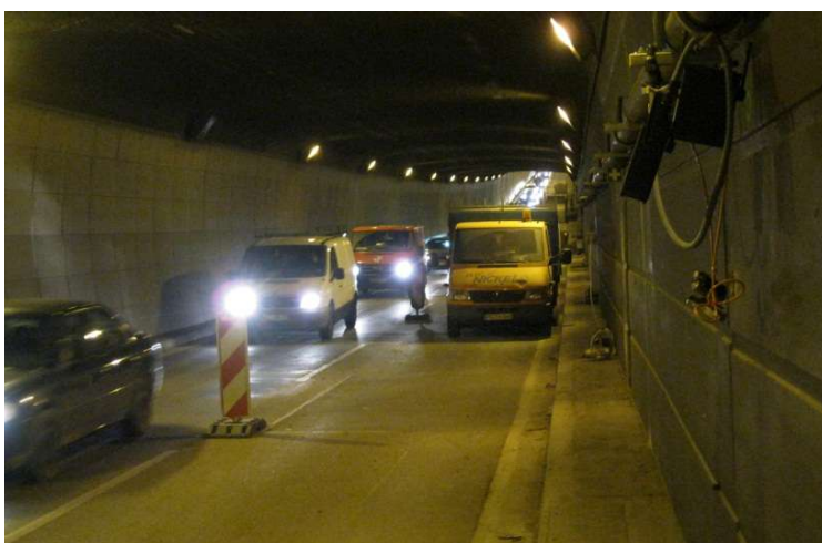
Abbildung 3: Dieselrußpartikel-Messung in einem Straßentunnel
