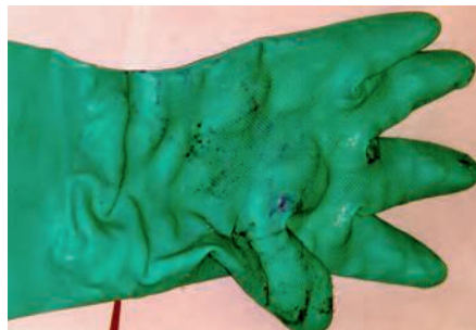
Abb. 2: Wurde in der Praxis noch nie beobachtet – so müsste mit dichlormethanhaltigen Abbeizern gearbeitet werden
