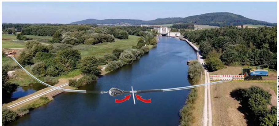
Abb. 1: Prinzip des HDD-Verfahrens
