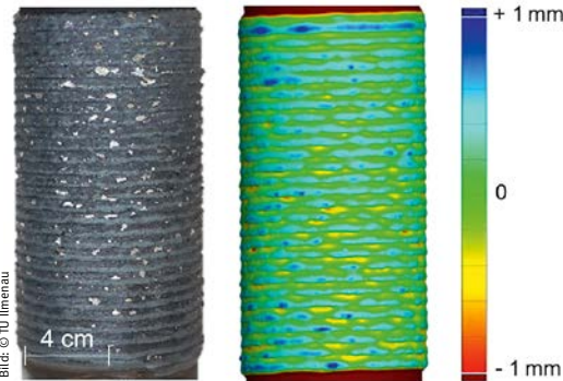
Abb. 4: Endkonturnähe des aufgeschweißten Rohrs mit einer Luftstrom-Innenkühlung von 500 l/min, Fotografie und 3-D-Scan mit Visualisierung der Abweichung zur Zielgeometrie
