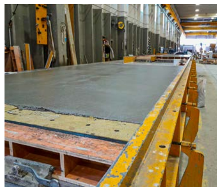
Eine fertig produzierte Wandscheibe
