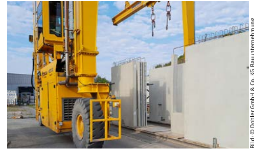
Die Fertigteile werden auf Innenlader-Paletten vorgeladen.
