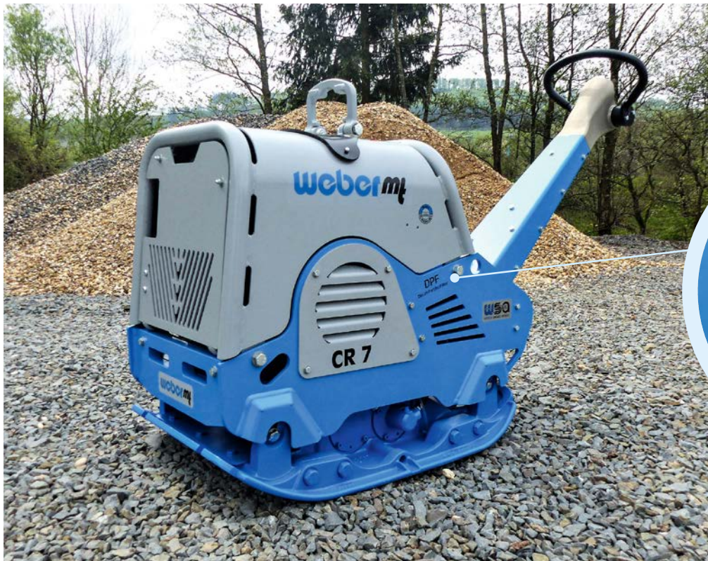
Rüttelplatte mit dem neu entwickelten Dieselmotor mit DPF
