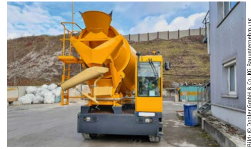
Vollelektrischer Betonmischer auf Basis eines Seitenstaplers
