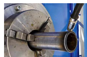
Abb. 3: Additive Aufarbeitung eines lokal verschlissenen Bohrgestänges mittels Lichtbogenschweißens
