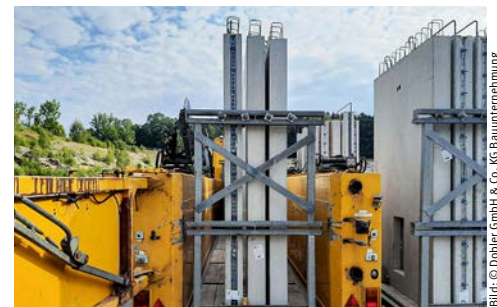
Durch die Bauart des Sattelauflegers können auch höhere Wandscheiben transportiert werden.
