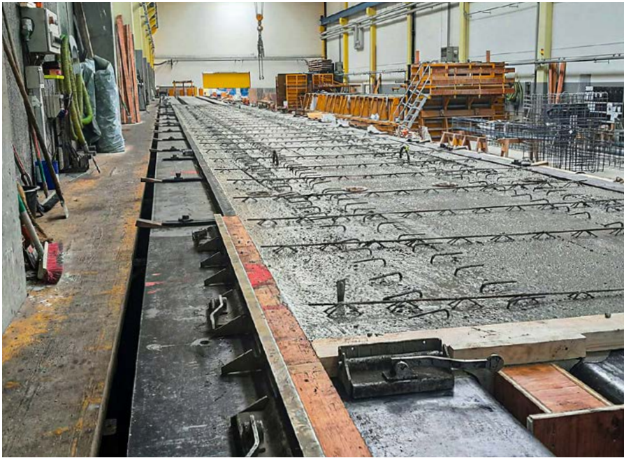
Vorfertigung der Betondecken-Platte
